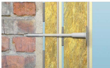
Attēls 1.4. Otrā sistēmas slāņa montāža uz esošas siltumizolācijas sistēmas ar minerālo vati
