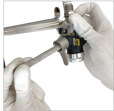
11 Uzstādiet filtru atbilstoši sprauslas tipam augstspiediena aparāta pistolē
