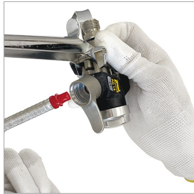
11 Uzstādiet filtru atbilstoši sprauslas tipam augstspiediena aparāta pistolē
