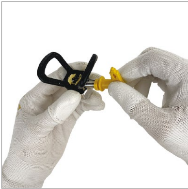
10 Uzstādiet sprauslu sprauslu turētājā
