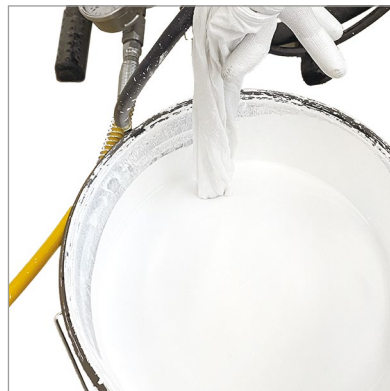
16 Ja nav rupja filtra, uz sūkšanas caurules varat ievietot filtru (piemēram, īpašu zeķi)
