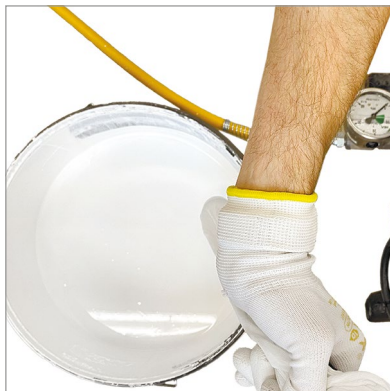
15 Ievietojiet augstspiediena sūkšanas cauruli (vai šļūteni) materiālā
